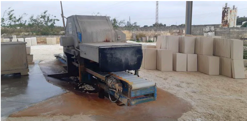
Fig. 44. Parte posterior por donde salen los bloques cortados: cuartos, quintos, medio, según número de discos para cortar.
