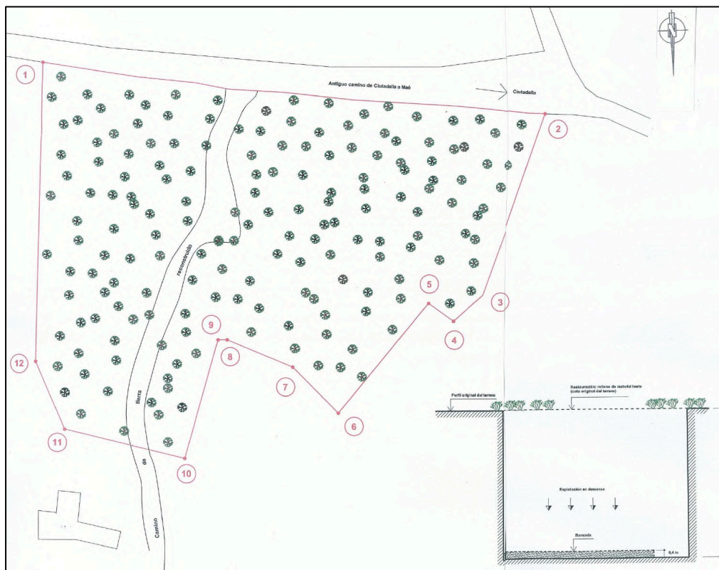
Fig. 7. Estado final de la cantera según proyecto de restauración actualmente aprobado de relleno a cota.
