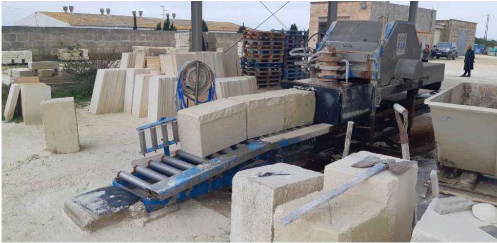
Fig. 43. Entrada de los blocs, en este caso 'redondas' 60x40x33 cm
