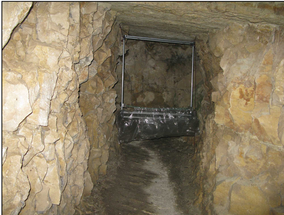
Foto 1: Trampa arpa pequeña instalada en uno de los pasillos de una gruta para la captura de los quiópteros.
