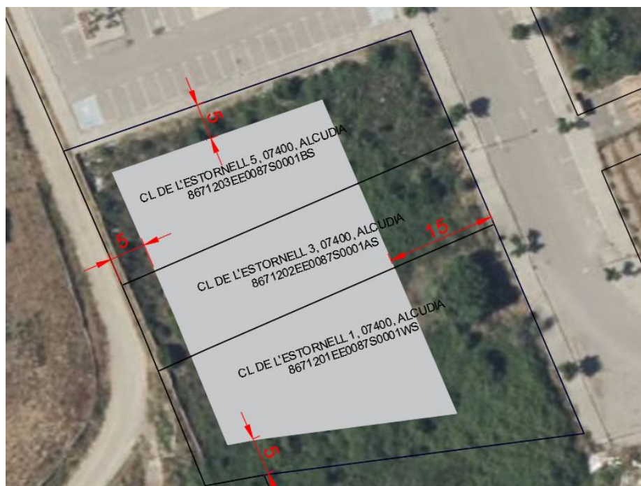
Imagen 6. Separación a deslindes final
