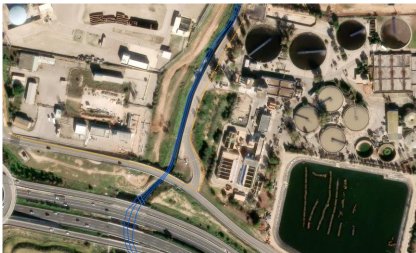
Figura 3.4.1.2.3. Canal/acequia identificada por donde se prevé un cruzamiento con la infraestructura de evacuación de las alternativas 2 y 3 (x: 473.333; Y: 4.379.391). La infraestructura de evacuación seguirá el trazado de la carretera existente de manera que en este cruzamiento discurra adosada a la misma, no previéndose afección sobre este torrente y canal
