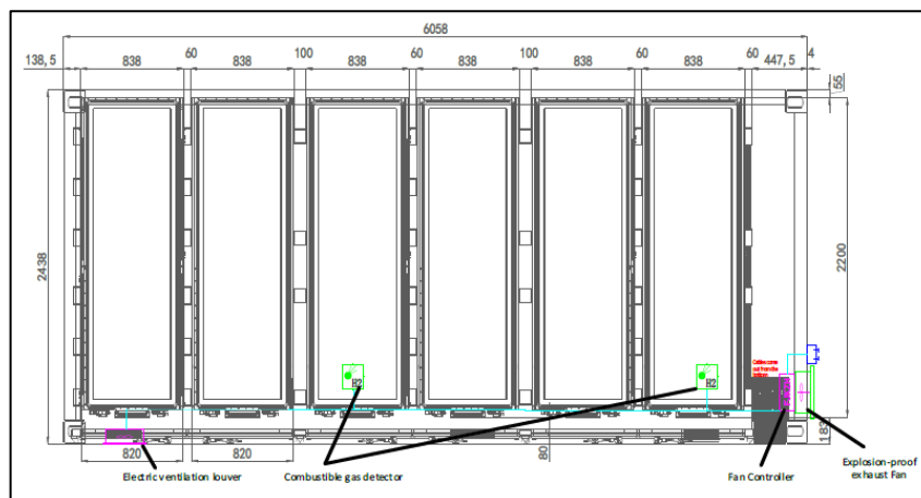
Imagen 19: Sistema de ventilación incorporado.
