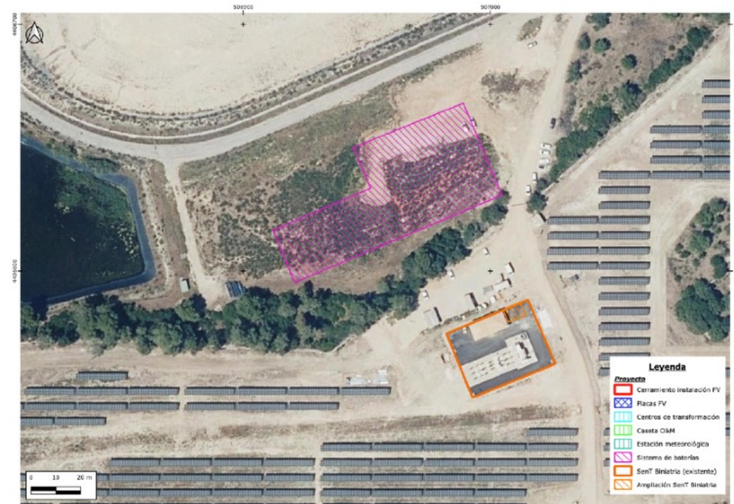
Localización de los sistemas de almacenamiento de energía.
