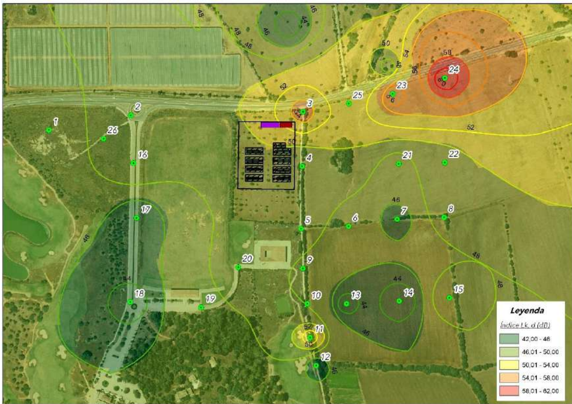
Figura 4. Isolíneas e interpolación de los niveles de presión sonora en inmisión registrados en las diversas estaciones de muestreo. Representación clasificada (Mapa R-03). Fuente: PODARCIS, S.L
