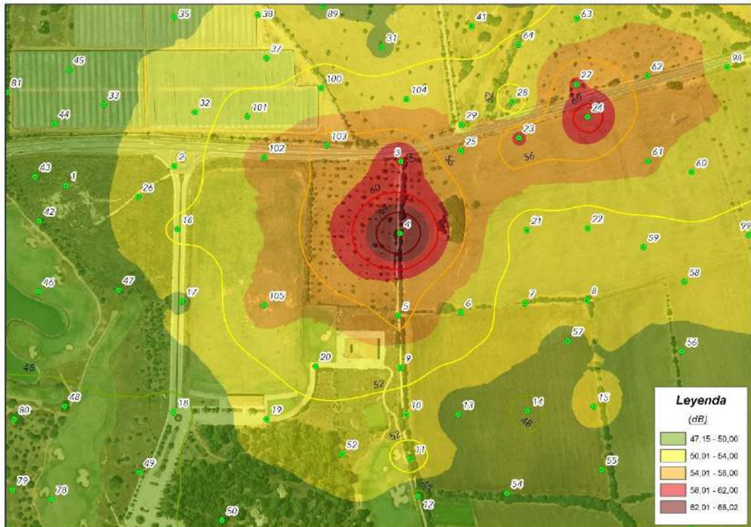
Figura 11. Simulación acústica del estado operacional. Representación clasificada (Mapa R-08). Fuente: PODARCIS, S.L
