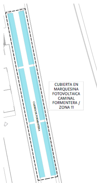
Imagen 22. Disposición de las placas fotovoltaicas en cubierta en marquesina aparcamiento en caminal de Formentera
