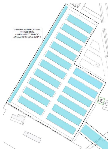
Imagen 18. Disposición de las placas fotovoltaicas en cubierta en marquesina de aparcamiento del edificio Anselm Turmeda
