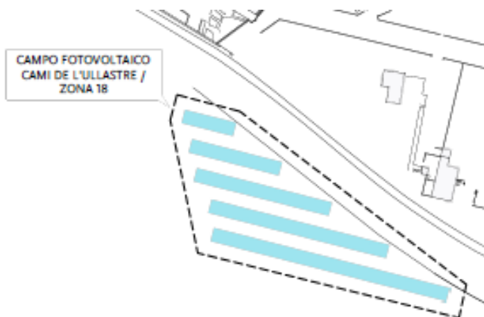
Imagen 36. Disposición de las placas fotovoltaicas en el campo de Camí de l'Ullastre
