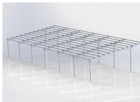
Figura 21. Exemple d'estructures metàl·liques continues prefabricades destinades a usos agrícoles que podrien servir per el desplegament del caminal solar
