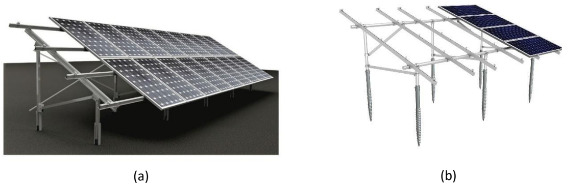
Figura 12. (a) Estructura fixada al sòl mitjançant hinxes. (b) Estructura fixada al sòl mitjançant cargols de terra.
