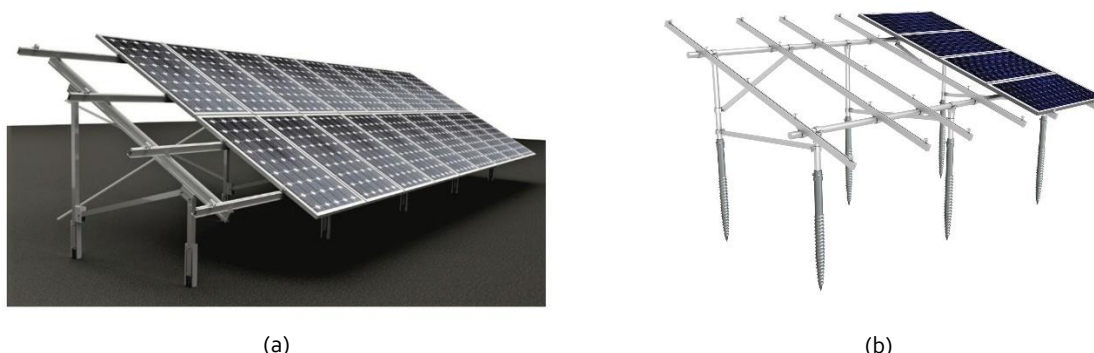
Figura 27. (a) estructura fixada al sòl mitjançant hinged. (b) Estructura fixada al sòl mitjançant cargols de terra.
