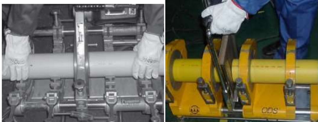
Equipo de soldadura por termofusión. Colocación de las tuberías y colocación de placa de calentamiento.
