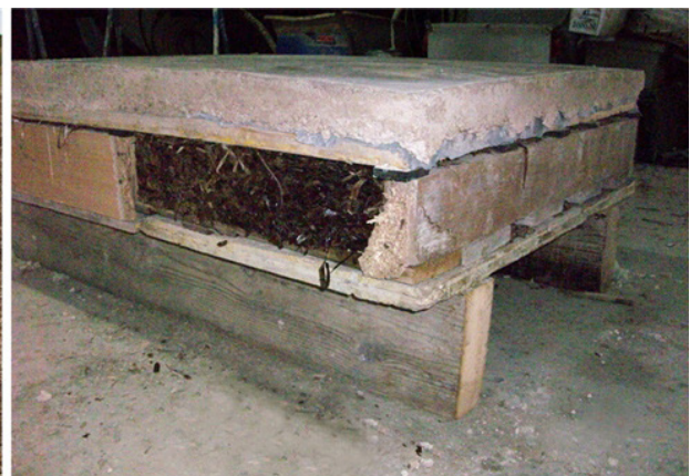
Maqueta de forjado a escala real con aislamiento de posidonia oceánica en palés reutilizados.
