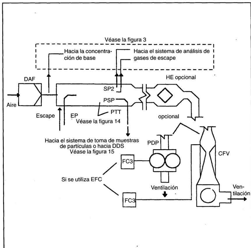
La cantidad total de gases de escape sin diluir se mezcla con el aire de dilución en el túnel de dilución DT.
