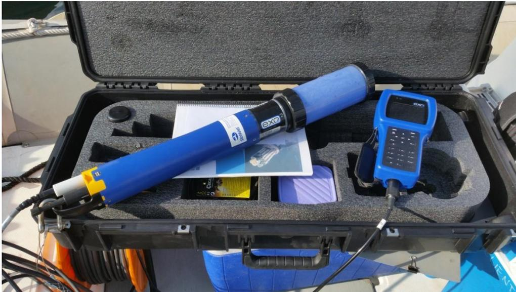
*Sonda multiparamétrica utilizada para realizar los perfiles de medidas in situ.*
