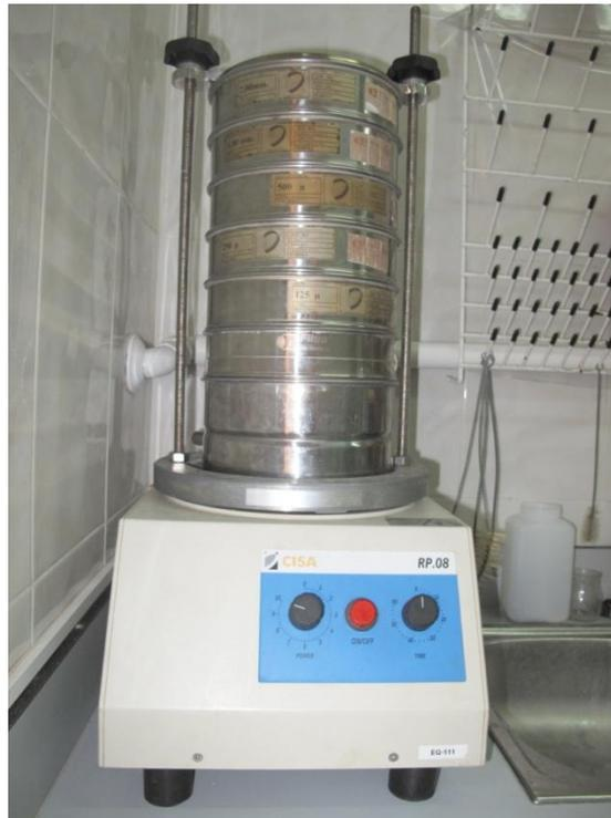
*Tamizadora electromecánica y batería de tamices.*
