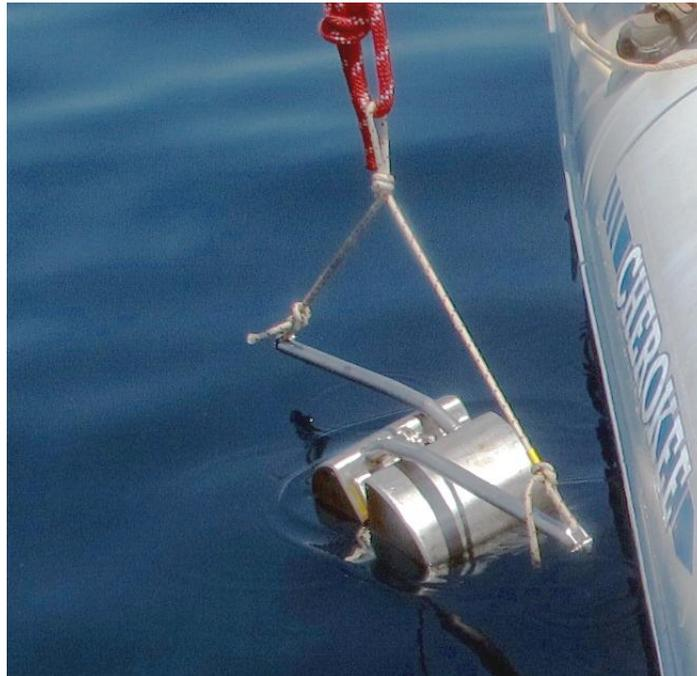
*Draga Van-Veen de doble cuchara utilizada para la toma de muestras de sedimento.*
