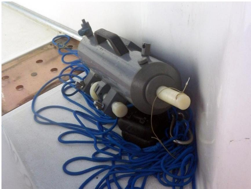
*Botella oceanográfica Niskin para la obtención de muestras a diferentes profundidades.*
