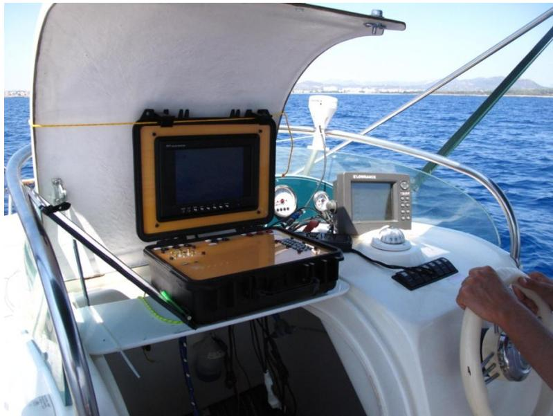
*Instrumentación a bordo para el vídeo remolcado: equipo de visualización- grabación y plotter con sonda y GPS.*
