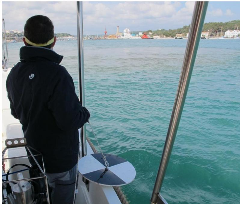
*Disco de Secchi utilizado para medir la transparencia de la columna de agua.*
